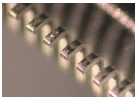
Пример измерения : высота пиков на QFP-корпусе
