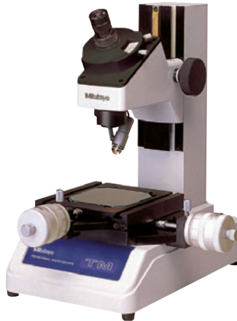
TM-505 с опциональными аналоговыми микрометрическими головками
