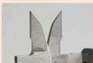
Губки с твердосплавными измерительными поверхностями
