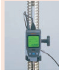
Цифровой индикатор Digimatic ID-N с кабелем 02AZD790D
