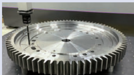
Сканирование головкой SP80 и щупом 100 мм.
